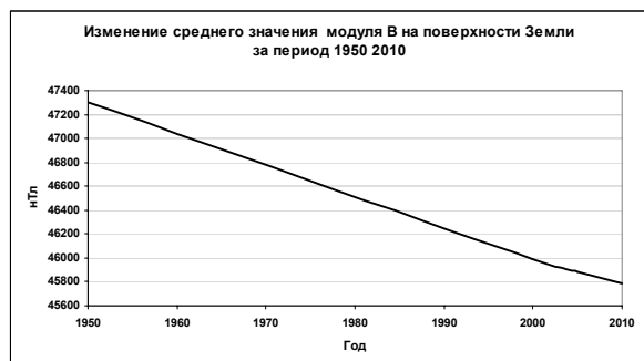
Рис. 2. Изменение среднего значения модуля B на поверхности Земли за период 1950-2000гг (расчеты с использованием [http://omniweb.gsfc..]).
